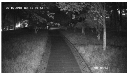
Tradycyjna kamera 4 MP (dioda LED podczerwieni włączona)
