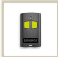
TO.GO2VA 84zł 9863173 Pilot 2-kanalowy uniwersalny 433,92MHz. Kod zmienny oraz ARC kod.
