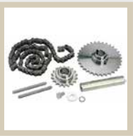
VN.RV 435zł 9520016 Zespół wału pośredniego 1:1,8 do wałka 1 calowego (25,4mm). Umożliwia szybsze otwarcie bramy.
