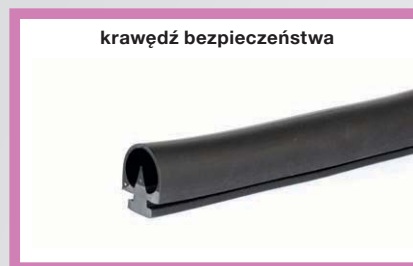
krawędź bezpieczeństwa SC.RES 165zł / SC.RL 465zł 9270060 9270061 Krawędź bezpieczeństwa z gumy przewodzącej. Szerokość 28,5 mm. Cena za 1 metr. Sprzedawane w odcinkach 5m. SC.RES: wysokość 25 mm. SC.RL: wysokość 65 mm.
