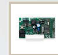
ONE.2WI 245zł 9673102 Uniwersalny odbiornik radiowy 433,92Mhz, 2 kanałowy. Możliwość zaprogramowania do 512 kodów.
