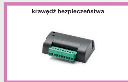
krawędź bezpieczeństwa SC.EN 338zł 9760026 Interfejs dla 8x2 krawędzi bezpieczeństwa. Stosowany w przypadku jeżeli centrala sterująca nie posiada wejścia do krawędzi bezpieczeństwa . Zgodne z normą EN12978.
